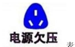
**电源欠压** 表示主机供电电源可能存在供电不足的现象，检查供电电压和电流。
